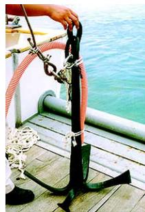
アンカーに固定した取水口
