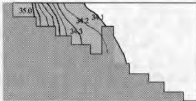
Fig. -6 塩分鉛直断面分布 (モデル A-2)
