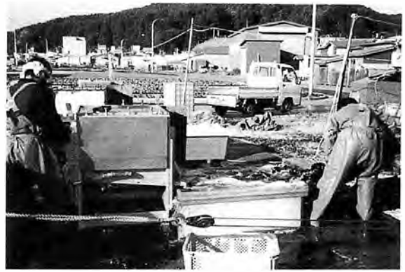
図1 陸揚げしたコンブの洗浄作業。コンブは写真左側の漁業者が中央左にある洗浄機にコンブを入れて、海水をかけ流しながらブラシでコンブ原藻に付着している夾雑物を除去後、右下にあるタンクに集める。北海道福島漁港（1999年）。
