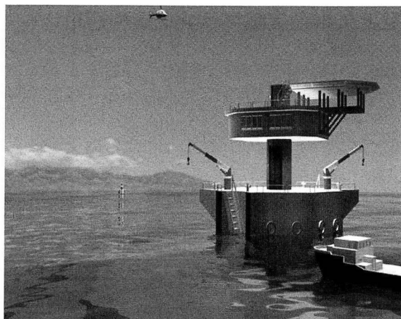
図7 型式認証(AIP)を取得した浮体式 OTEC の概念図
