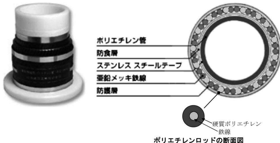
図2-2 鉄線鎧装硬質ポリエチレン管(古河電工(株)製)
