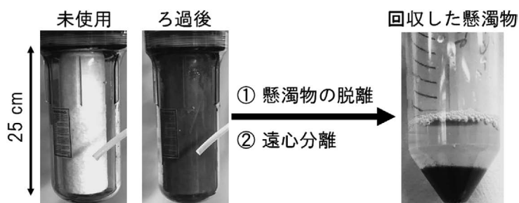
図4 ろ過フィルターからの懸濁物の回収
